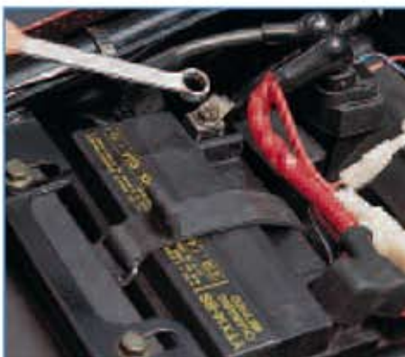
2. Eerst de minkabel, daarna pas de pluskabel losmaken
