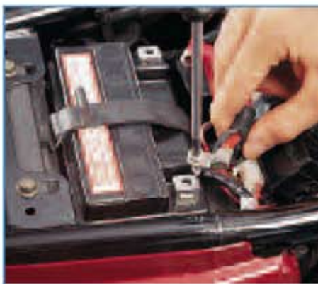
5. Eerst de pluskabel, daarna de minkabel bevestigen.
